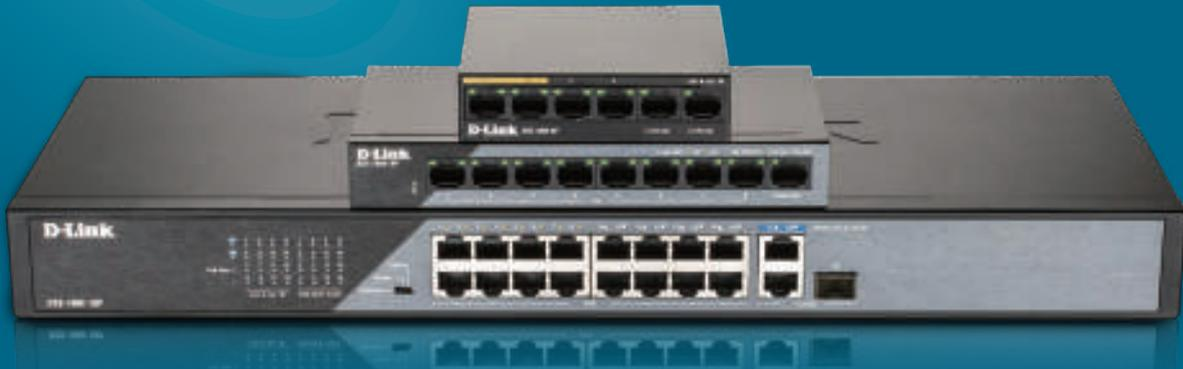
Коммутаторы серии **DSS-100E** с увеличенной дальностью PoE рекомендуются для применения в системах видеонаблюдения в местах с ограничениями по размещению источников электропитания. Устройства обладают высоким бюджетом PoE, оснащены встроенной защитой от статического электричества до 6 кВ и обеспечивают подключение удаленного PoE-оборудования на расстоянии до 250 м, а при использовании дополнительных PoE-повторителей D-Link DPE-302GE – до 650 м.
